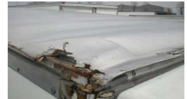
Zona del techo: Armazón dañado, la piel no merece la pena de repararse
