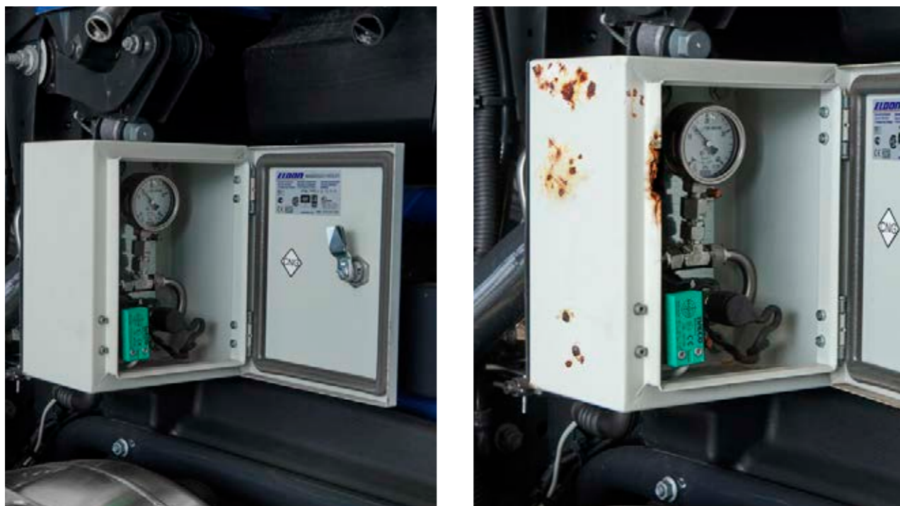
Óxido en el cárter de protección del receptáculo de llenado → sin cargo por daños.
