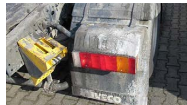
Profunda decoloración debido a los elementos químicos
