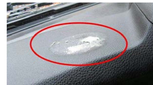
🔄 Tela y perfil de plástico: Desgarro, agujero > 5 mm, marcas indelebles
