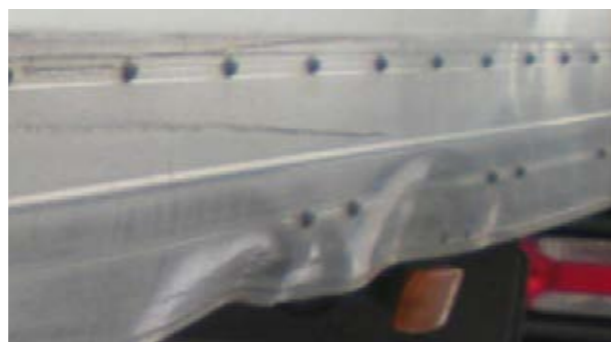
Perfiles laterales de los bajos de la carrocería: Deformaciones que no merece la pena de reparar, perforaciones, eliminación de una sección del perfil
